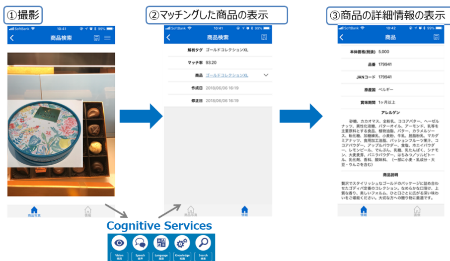
図： AIでの画像認識からアプリケーションでの商品表示の流れ
