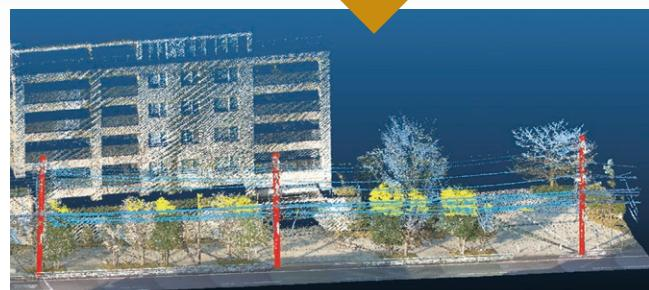
車載センサのMMSにより、設備の3D点群データを取得。
